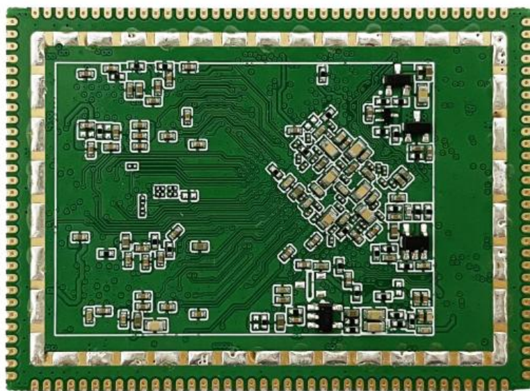
图 3. QM-SOM3568J-V1 核心板背面
