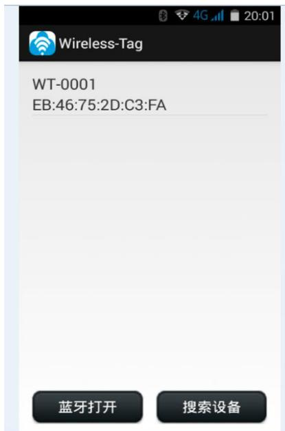
与蓝牙设备配对连接，并在发送串口窗内输入数据，向蓝牙模块设备发送数据，模块接收到 APP 发送的数据之后，通过 DEMO-KIT 将收到的数据推送到串口，并在 PC 端的串口调试工具中得以显示：
