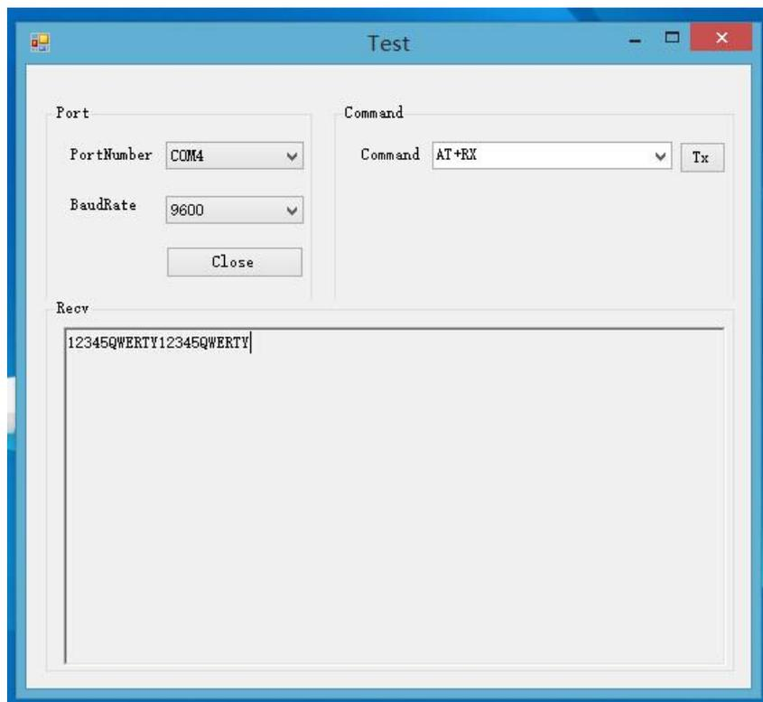
也可以通过 PC 端的串口调试工具，通过模块向 APP 串口工具发送数据，APP 通过显示窗口显示出接收到模块发回的数据：
